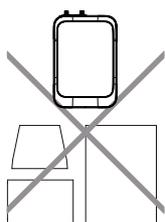
Нельзя монтировать установку «Siberia Home», рядом с нагревательными и излучающими тепло приборами: газовые котлы и плиты, электроплиты, микроволновые печи и т.п.
