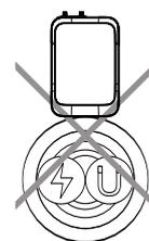
Избегайте мест монтажа рядом с силовыми электрическими кабелями, источниками электромагнитного излучения, магнитными полями.
