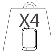
Несущая способность стены, на месте монтажа, должна быть в 4 раза больше общего веса установки «Siberia Home», после заполнения водой (около 20кг), в противном случае необходимо установить опорную подставку для обеспечения безопасности.
