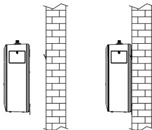
(4) Отметьте и просверлите сверлом диаметром 8 мм , отверстие под крепеж к стене настенного фиксатора, закрепите установку , с помощью дюбеля и самореза.
