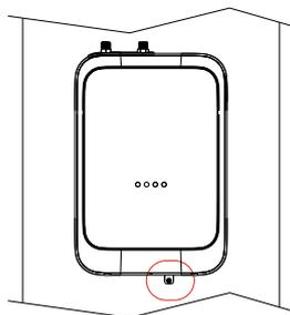
(5) Подключение электропитания: соедините водонепроницаемые разъемы адаптера и установки, подключите адаптер питания к сети.
