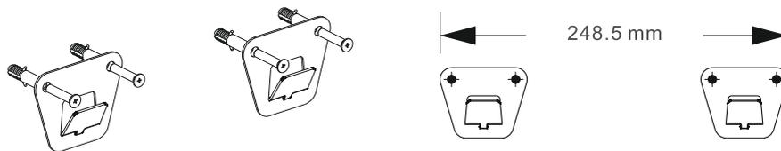
(2) Установите настенный фиксатор в нижней части установки, закрепите в быстроразъемном разьеме дренажную трубку необходимой длины.
