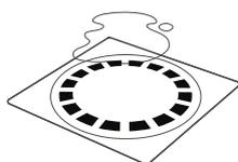
Производите монтаж установки рядом с дренажным трапом или канализационным сливом.
