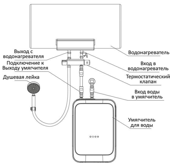
Схема подключения к электрическому водонагревателю
