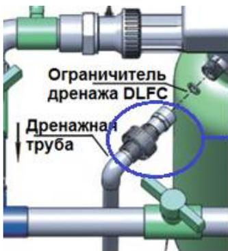
Соединение дренажного патрубка клапана с дренажной трубой (в комплект не входит)
