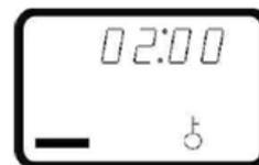
Цветная полоска в углу экрана показывает, что клапан находится в рабочем режиме: время начала регенерации – 02:00 (не отображается, если регенерация настроена по часам).
