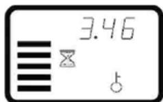
(Данная единица не отображается, если клапан управления настроен по времени). Цифры 3.46, символ
