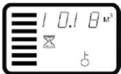
Цифры 10.18, символ
